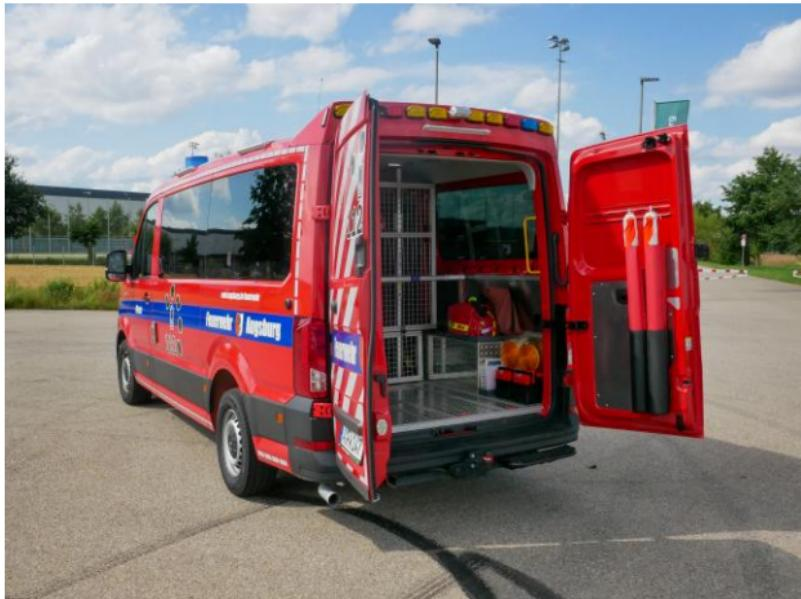
Der MTW dient in erster Linie dem Transport von Einsatzkräften. Mit acht Sitzplätzen wird er für Alarmfahrten, Übungen, Ausbildungen sowie für organisatorische Fahrten eingesetzt. Darüber hinaus übernimmt das Fahrzeug logistische Aufgaben, wie den Transport von Material oder die Zuführung von Personal an Einsatzstellen. Durch die Möglichkeit, Rollcontainer über das Heck aufzunehmen, kann der MTW flexibel an unterschiedliche Einsatzlagen angepasst werden.
