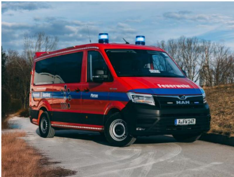
Insbesondere bei Unwettereinsätzen kann er mit Geräten wie Kettensägen, Tauchpumpen oder Absperrmaterial beladen werden und eigenständig kleinere technische Hilfeleistungen durchführen. Als Basisfahrzeug dient ein MAN TGE mit einem zulässigen Gesamtgewicht von 3.500 Kilogramm. Der Motor leistet 177 PS, die Kraftübertragung erfolgt über ein manuelles Sechsganggetriebe. Die Kabine bietet ausreichend Platz für die Besatzung sowie für die dauerhaft mitgeführte Grundausstattung.
